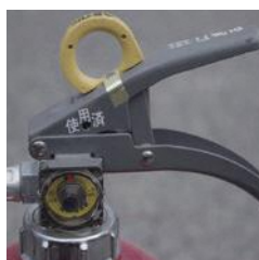
× 表示装置の脱落
