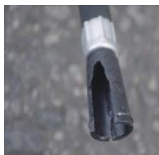
× ノズルの破損
