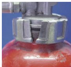
× キャップの破損
