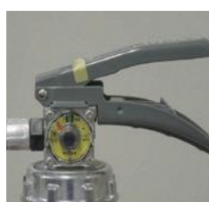
× 安全栓の脱落
