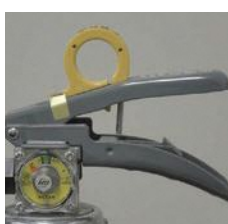
× レバー支えの脱落
