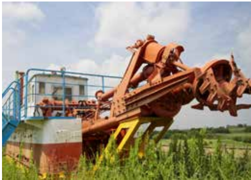
先端のカッターで削った土砂はパイプを通して陸上に
