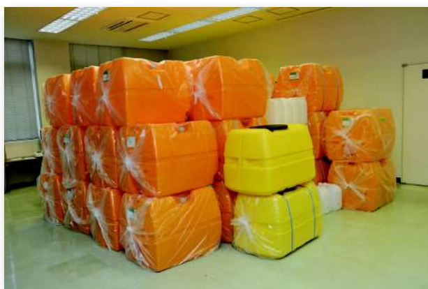
300リットルのローリータンク
