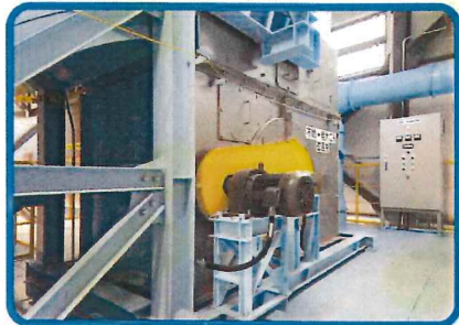
不燃・粗大ごみ磁選機 鉄類を選別・回収します。
