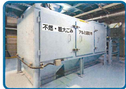
不燃・粗大ごみアルミ選別機 アルミ類を選別・回収します。
