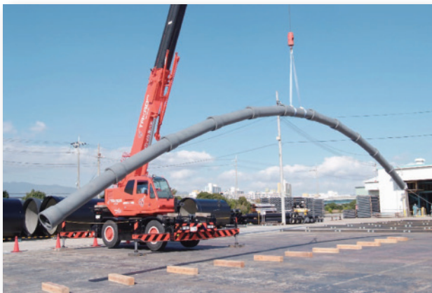
耐震継手ダクタイル鉄管の吊上げ試験 (出典：日本ダクタイル鉄管協会)
