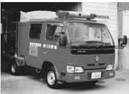
購入予定と同型の小型動力ポンプ付積載車
