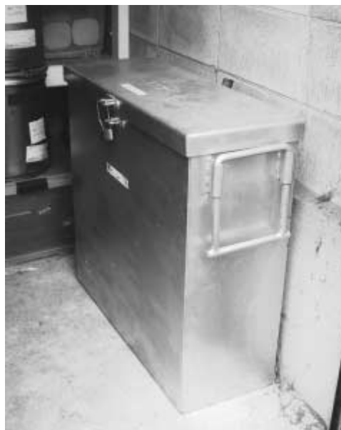
PCB汚染物保管場所にある耐腐食性金属容器
