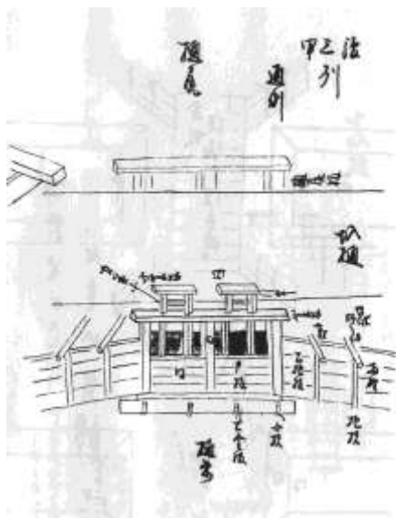
坎樋の構造絵図および名称 上段：樋尻の絵図 下段：樋前の絵図
