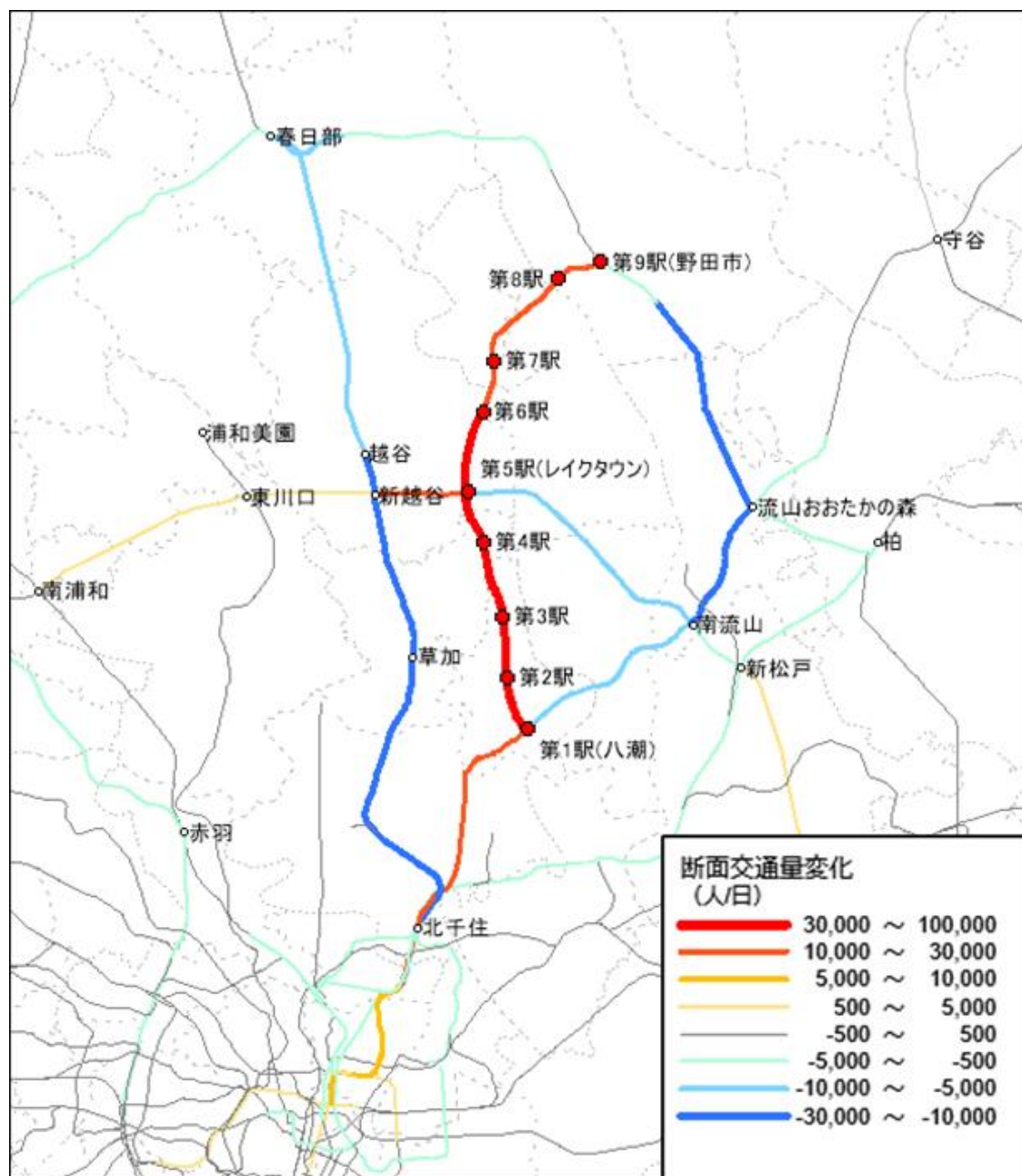
図 8号線整備による周辺路線断面交通量の変化（基本ケース）
